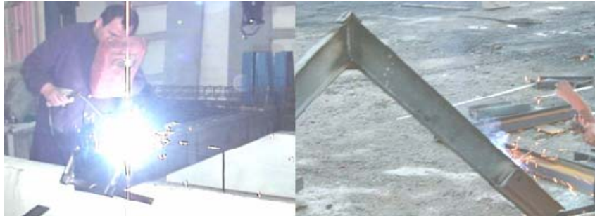
Resim 6. Elektrot kaynağında arkın oluşumu
