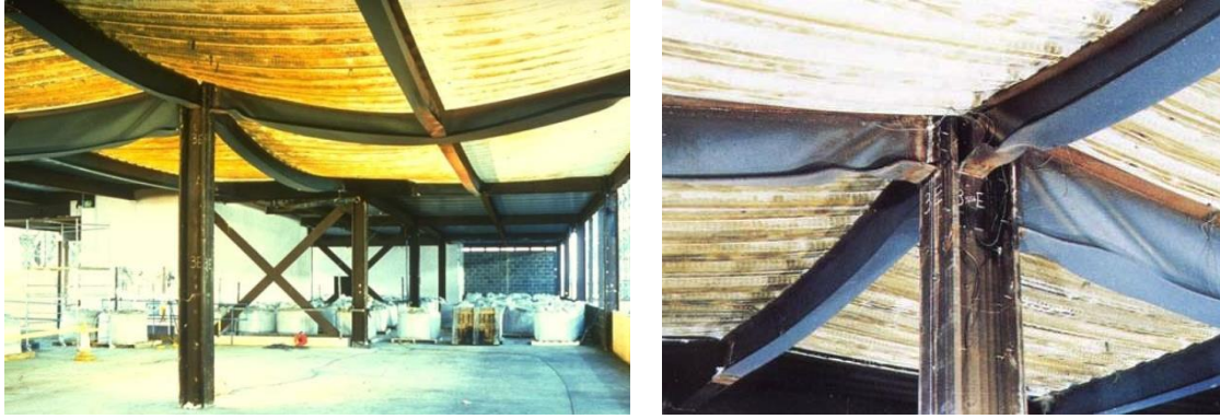
Resim 4-5: Çelik taşıyıcılı döşemenin standart yangın testinde deformasyonu ve yüksek ısı karşısında burkulan kiriş-kolon bağlantısı 5
